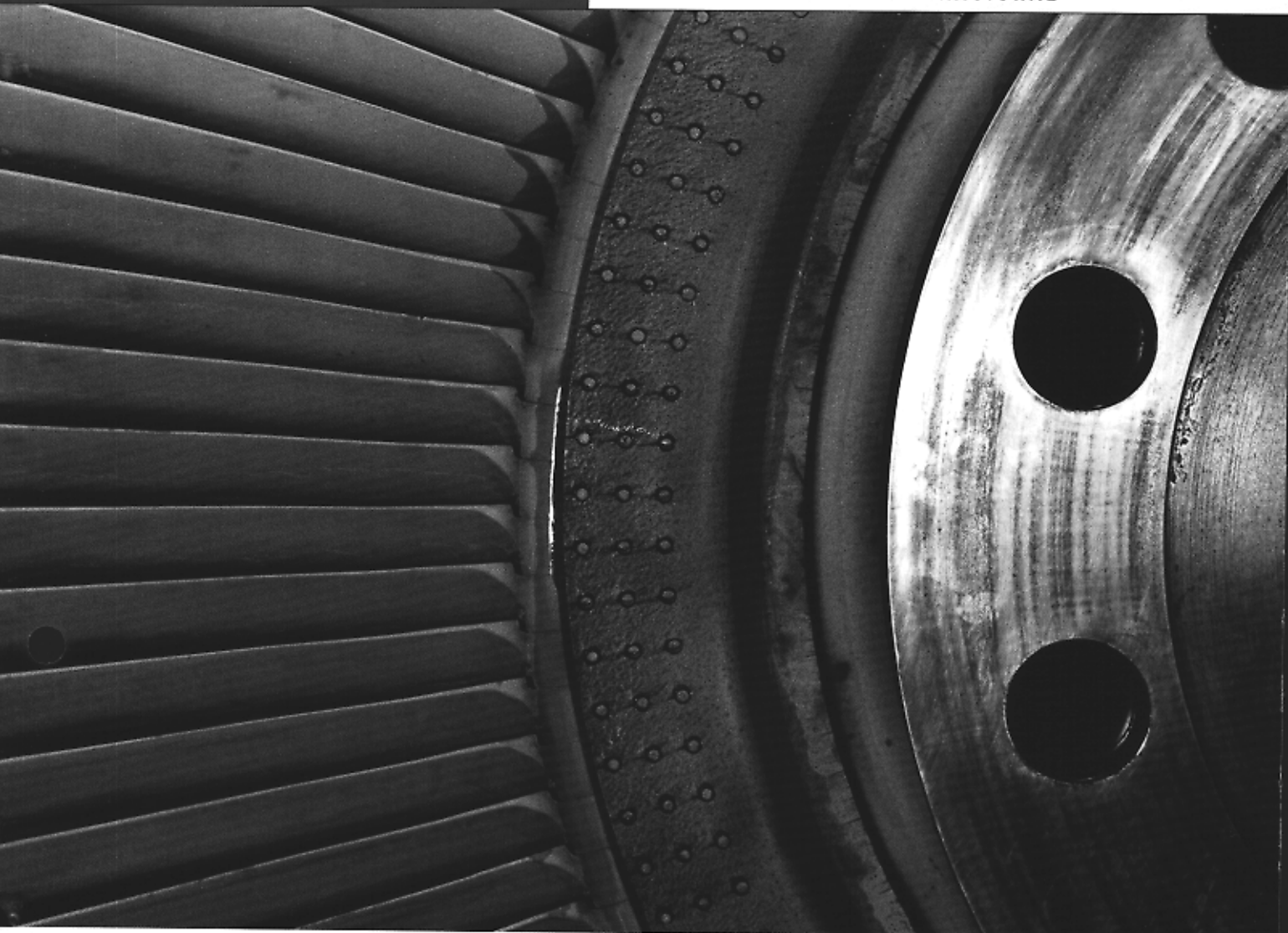
Detalle del rotor de la turbina de vapor de la Unidad 1 de Ventanas
