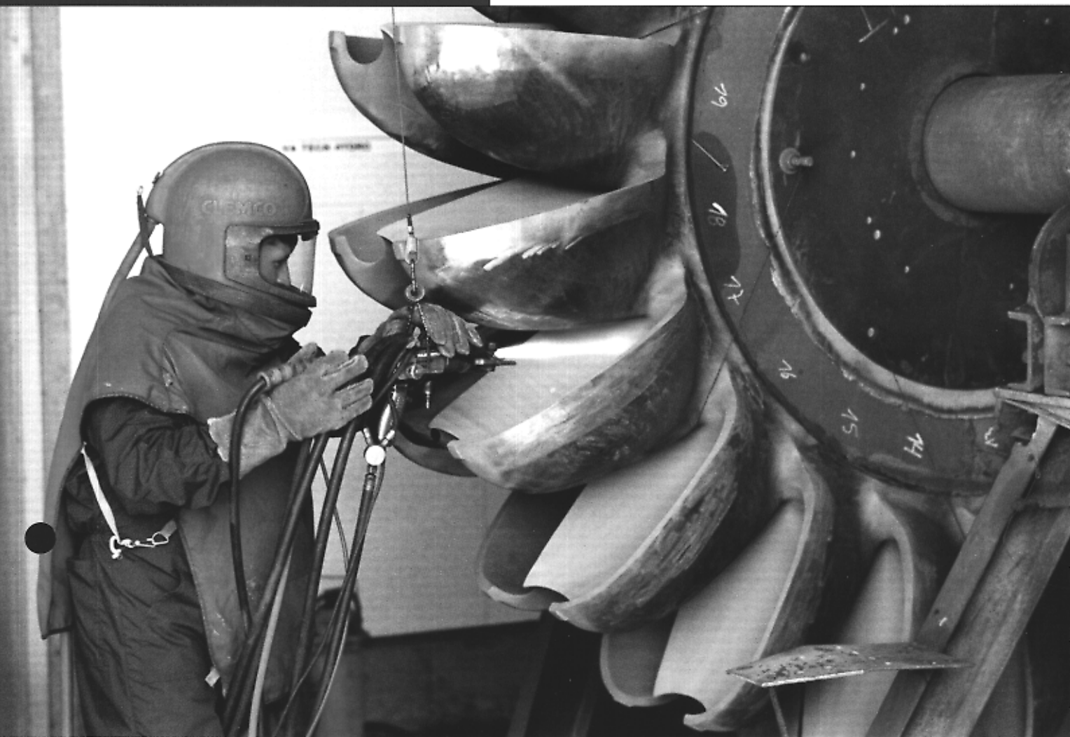
Recubrimiento de álabes de turbina de Ailafal con carburo de tungsteno, para aumentar su vida útil
