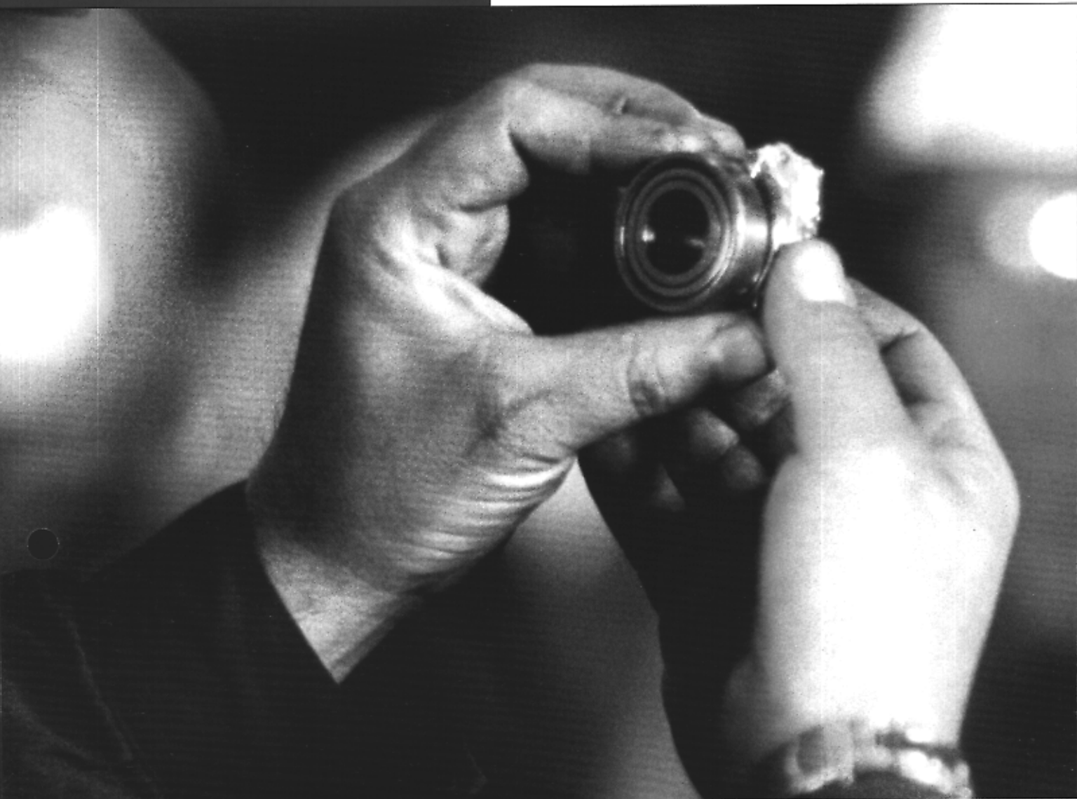
Inspección de rodamiento. centro Ventanas
